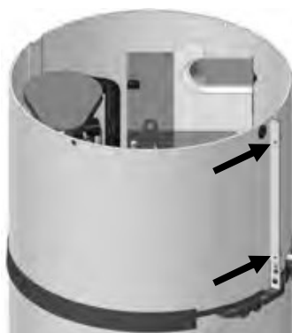
Schroef de 2 schroeven van de voorkap los
